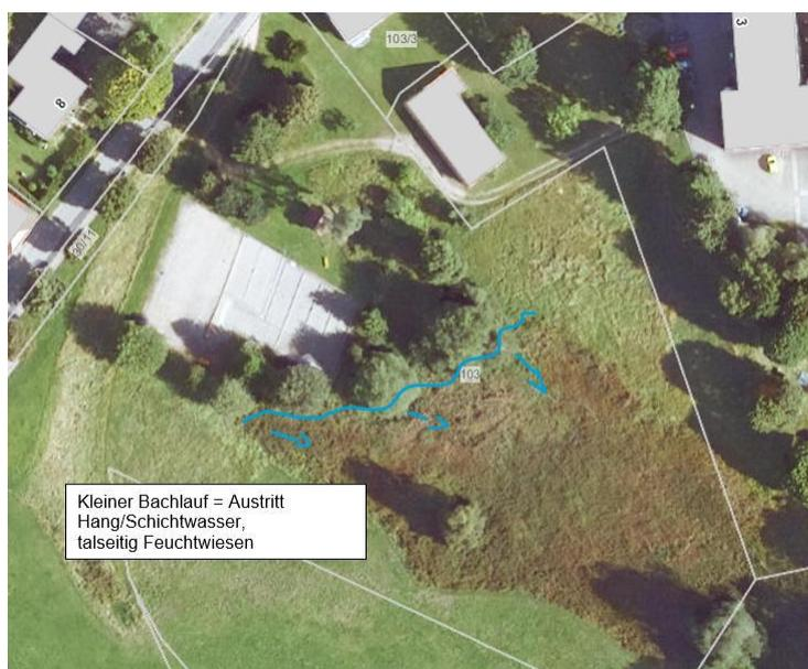
**Abbildung 2: talseitig des Baufeldes Schichtwasseraustritte / Feuchtwiese**
