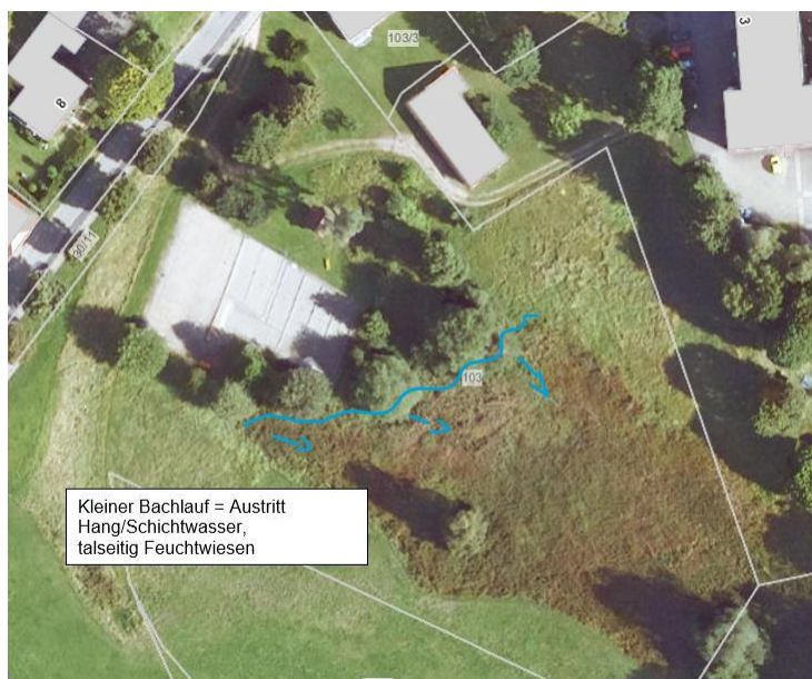
Abbildung 2: talseitig des Baufeldes Schichtwasseraustritte / Feuchtwiese
